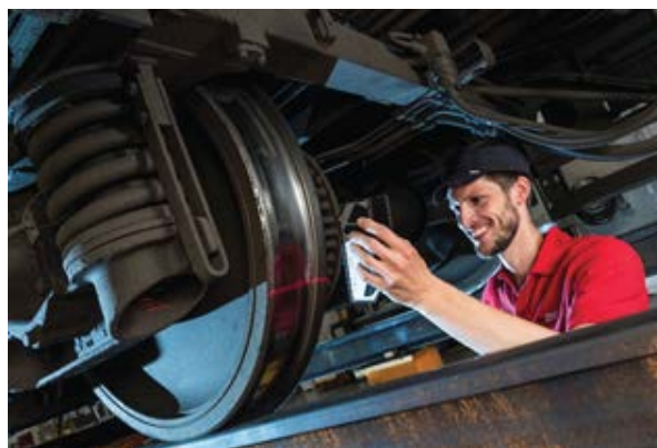
MĚŘENÍ PROFILU KOLA S CALIPRI
