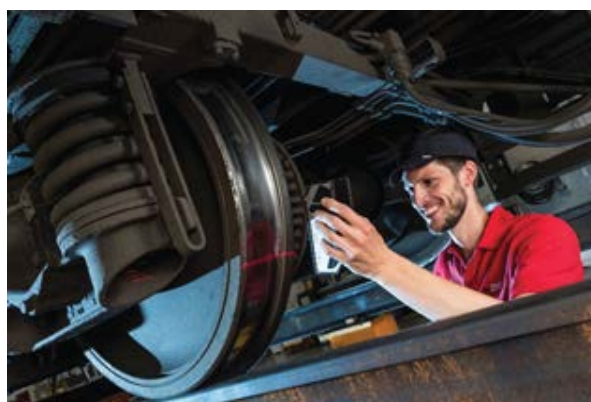
MĚŘENÍ PROFILU KOLA S CALIPRI
