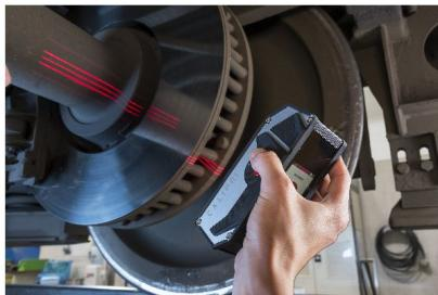
Bezkontaktní metoda měření CALIPRI vyžaduje jen krátké zaškolení a následně poskytuje přesné měření bez vlivu uživatele.
